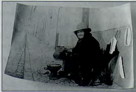
Figura 101 — Prova em papel de revelação plastificado, apresentando levantamento e rasgo do revestimento de polietileno.
