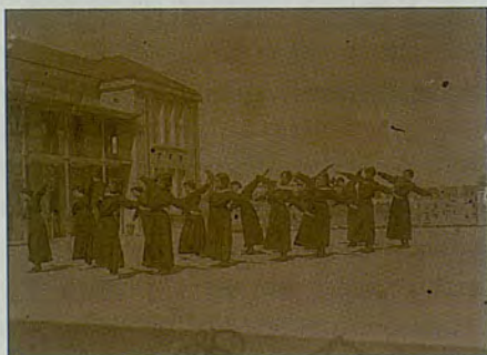
Figura 67 — Prova em papel directo, que sofreu uma sulfuração acentuada e como consequência apresenta cor esverdeada.
