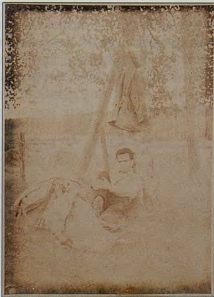
Figura 71 — Prova a cor cromogénea, datando de cerca 1950, que sofreu desvanecimento muito acentuado por acção da luz.
