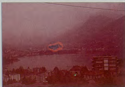
Figura 73 — Diapositivo cromogéneo, datando de 1964, conservado no escuro, em que os corantes ciano e amarelo desvaneceram totalmente.
